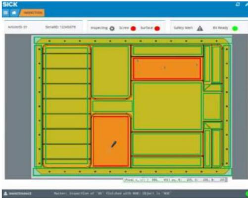
In der Prüfstation werden mittels SICK Kameras Aufnahmen der Batterie gemacht und ausgewertet. Erkennen die Kameras Fremdkörper, werden diese mittels einer schematischen
