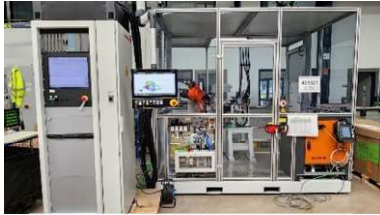
Statisch-elektrischer Prüfstand mit Leistungselektronik; SEP mit LE)
